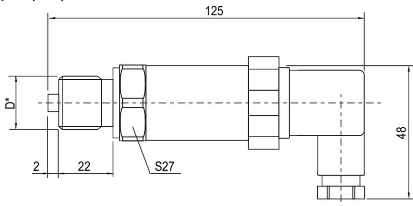
D\* - тип резьбы процессного соединения зависит от исполнения.
